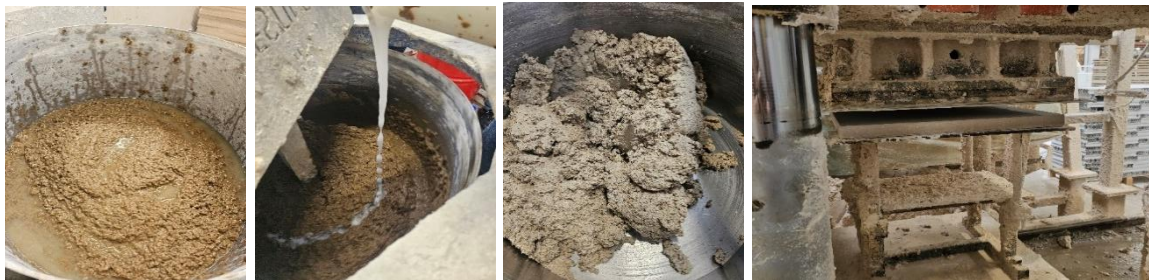
Şekil 7. Kalsiyum sülfat esaslı atık kağıt lifi ve nanoselüloz takviyeli kompozit levha üretim prosesi.
