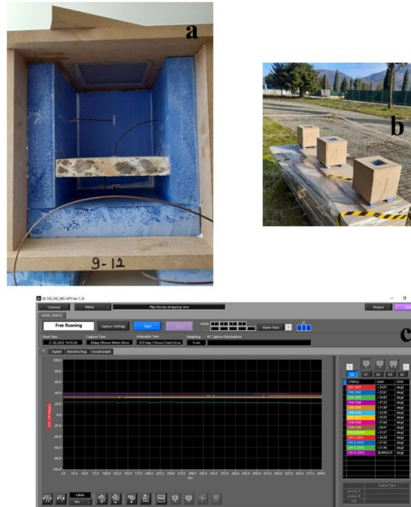
Resim 6. (a) Enerji depolama performans ölçümü için hazırlanan odanın iç görünümü ve Termokupl'ların yerleşimi, (b) Enerji depolama performans ölçümü için hazırlanan deney düzeneğinin görüntüsü, (c) Enerji depolama performans ölçümü için sıcaklık verilerini 5 sn aralıklarla kaydeden Data Logger arayüzü.
